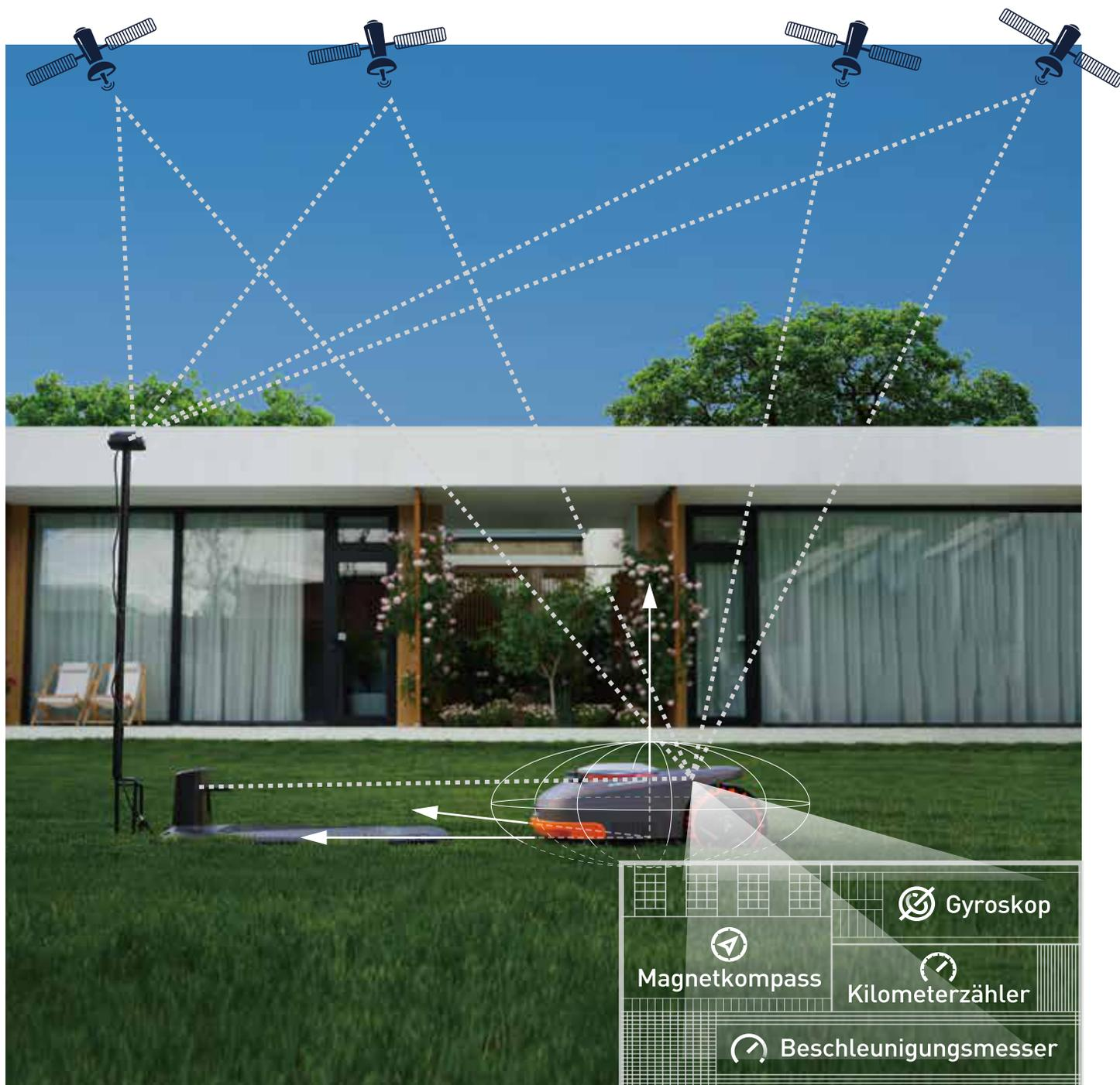
Mit dem Exact Fusion Locating System (EFLS) von Segway Navimow kann die virtuelle Begrenzung, basierend auf satellitengestützter Technologie mit einer Positionierungsgenauigkeit bis auf wenige Zentimeter genau angelegt werden, ohne dass ein Begrenzungskabel erforderlich ist.
