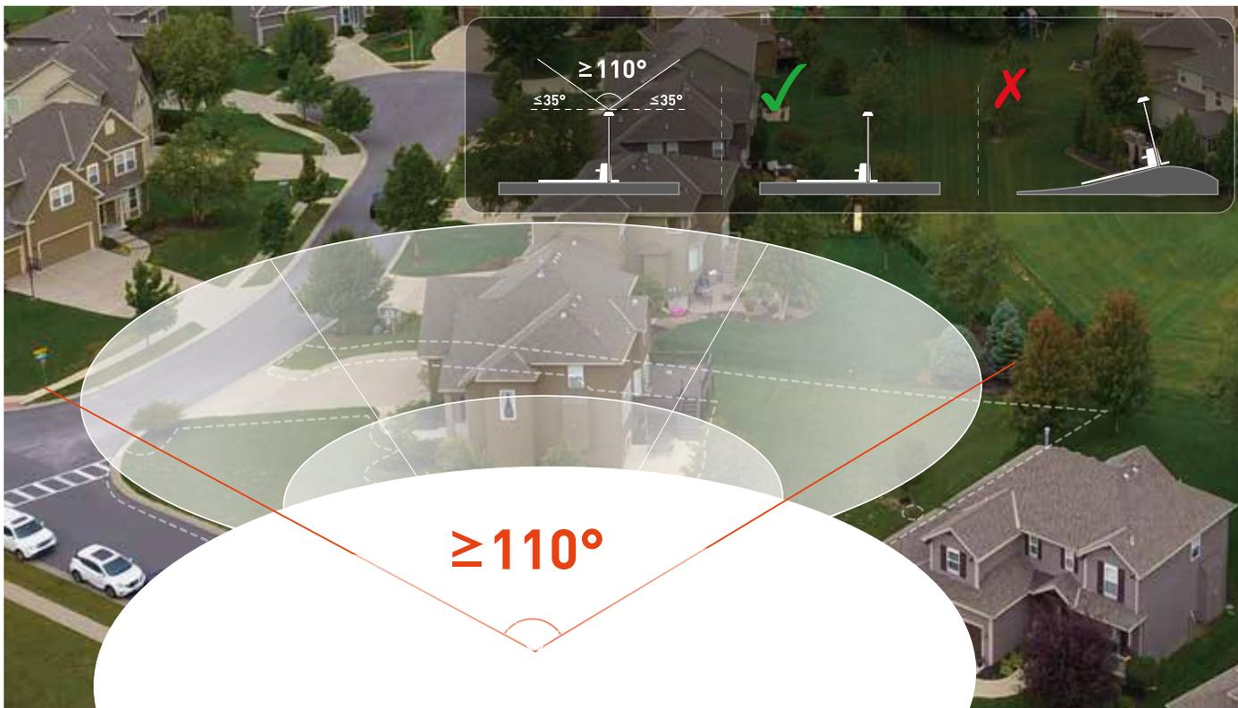
Um ein starkes GNSS-Signal zu gewährleisten, muss die Antenne auf einer offenen Fläche mit einer ungehinderten Sicht von mindestens  $110^\circ$  zum Himmel installiert werden.
