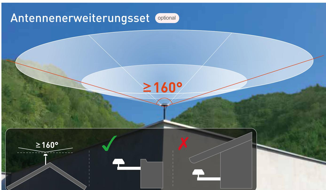
Sollte die im Lieferumfang enthaltene GNSS-Einheit nicht genügend Empfang erhalten, ist eine GNSS-Zusatzeinheit als Erweiterungsset erhältlich. Um ein besseres Signal zu erhalten, installieren Sie die Antenne an einer freien Fläche mit einer ungehinderten Sicht von mindestens  $160^\circ$  auf den Himmel.
